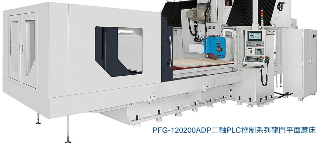
PFG-120200ADP二軸PLC控制系列龍門平面磨床
