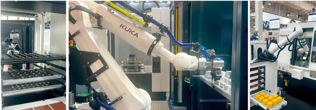
DMG MORI也針對未來無人化工廠，依照加工設備與產線需求展示了各種不同功能的無人搬運車、移動式機器手臂、刀具備刀運搬車等，可進行物料、鐵屑車、大型料件、備刀刀具運搬等，以生產管理系統進行零件製造生產排程後，透過智慧製造執行系統，
