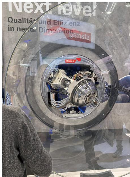
圖16. Sprint Z3五軸同動銑削加工
