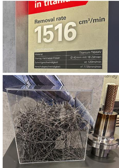
圖17. S1250高性能五軸聯動靜壓加工中心鈦合金移除率
