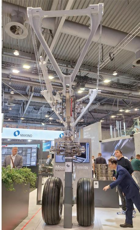
圖15. 空中巴士A350前起落架系統
