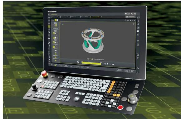
實現複合加工的可能性：TNC7現新增刮削、外徑研磨及圓柱表面加工的新循環功能
