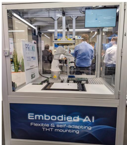
圖8. ProKI-Aachen中心展示AI視覺輔助電路板上進行元件的自動化插件
