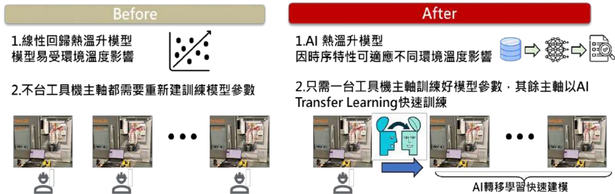
圖 8 遷移式學習 AI 主軸熱變數位模型訓練流程
