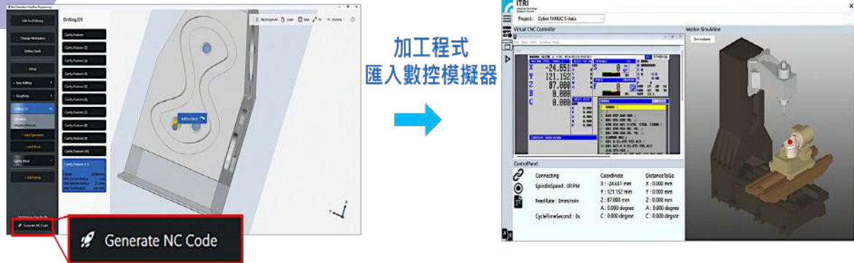
圖 10 工研院五軸工具機數位雙生平台整合 ModuleWorks CAM Engine
