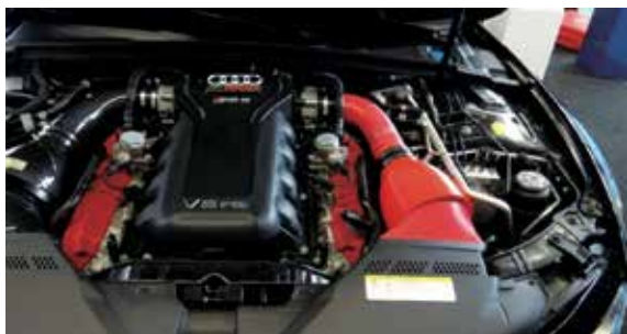
圖5 Audi採用Ultimaker 3D列印機於進氣系統研發原型
