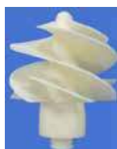
圖3、鈦合金離心泵導引葉輪之逆向工程與五軸加工
