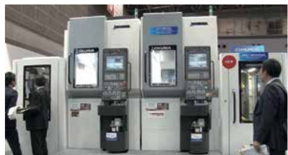
圖15、OKUMA推出兩台一體的五軸立式加工機
