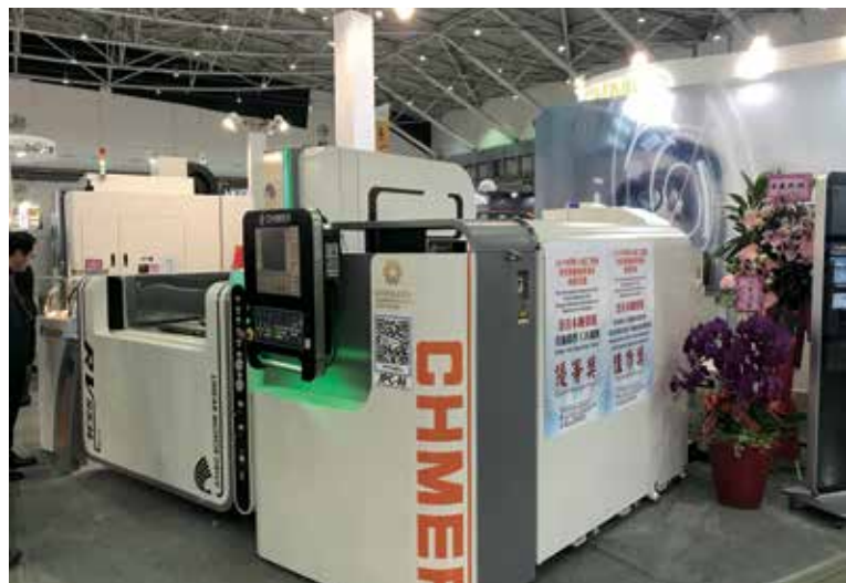
圖9、慶鴻機電RV853L智能化線性馬達驅動線切割機
