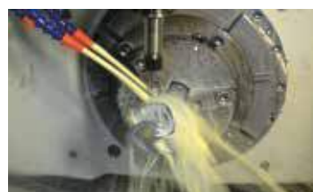
圖3、鈦合金離心泵導引葉輪之逆向工程與五軸加工
