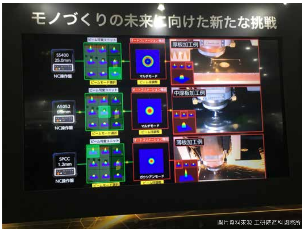
圖1、AMADA提出九種雷射模式應用於不同厚度板金
