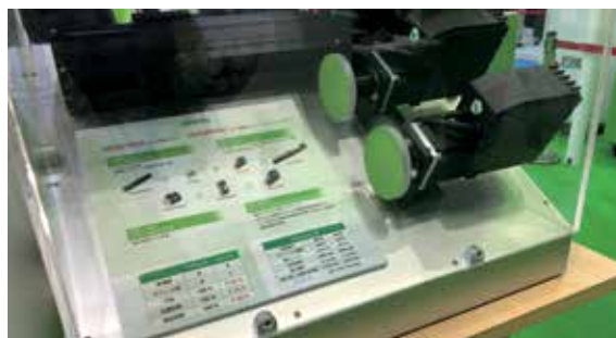
圖4、HIWIN驅動器結合同步馬達
