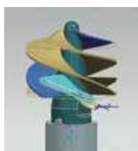
圖3、鈦合金離心泵導引葉輪之逆向工程與五軸加工
