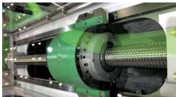
圖2、HIWIN轉矩馬達搭配螺桿上的螺帽
