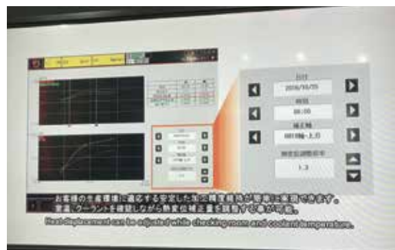
圖(四) MAZAK SMOOTH THERMAL SHIELD熱變位補正功能
