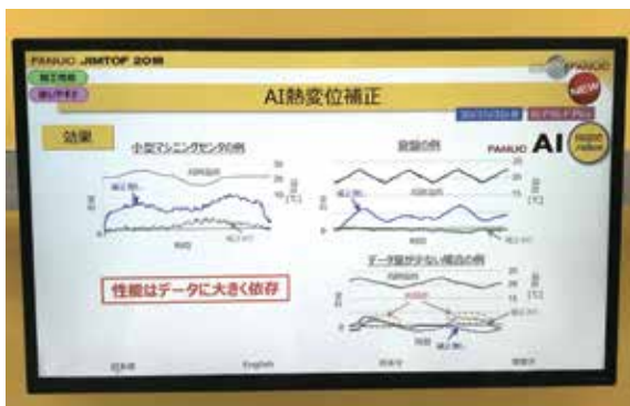
圖(三) FANUC AI熱變位補正效果
