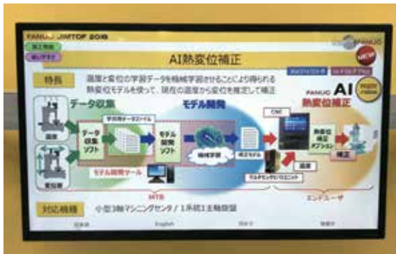
圖(二) FANUC AI熱變位補正
