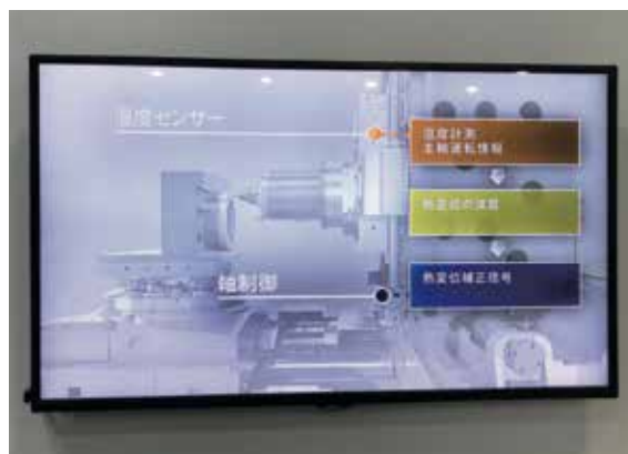
圖(八) OKUMA智能化技術-熱變位補正
